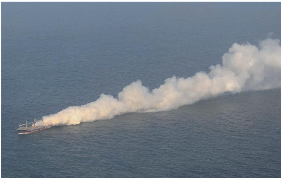
*Der Zersetzungsprozess in der Ladung vom ammoniumnitrat-haltigen Düngemitteln hatte im Mai 2015 auf der „Purple Beach“ (links) unter immenser Rauchentwicklung voll eingesetzt. Die Bekämpfung dauerte mehrere Tage. Anschließend hatte das Schiff nur noch Schrottwert.*
