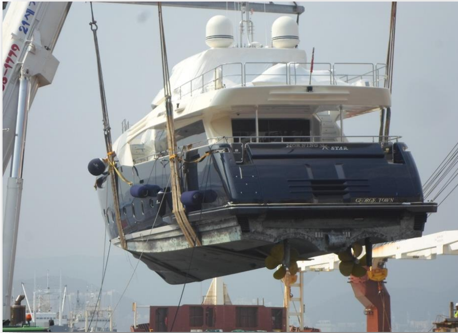
Vertikalausrichtung Kran fehlerhaft
