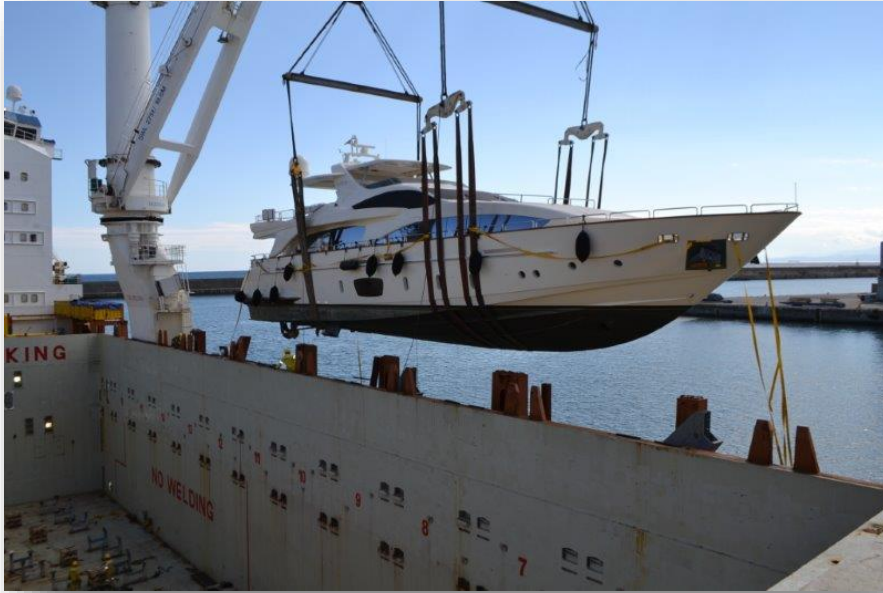
Bug-Equalizer ungleich – Slipgefahr!
