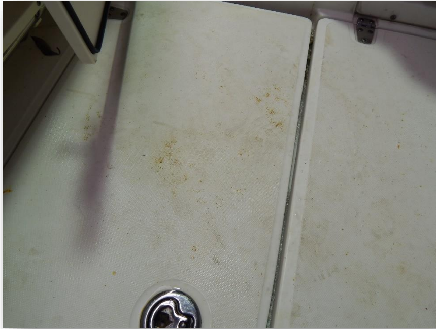
Rost an Deck durch Schiffsabgase
